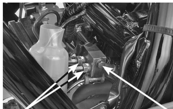
PORCAS DA CONEXÃO PARAFUSO
