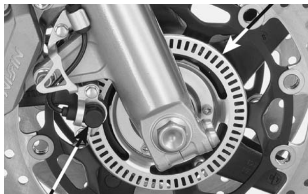
SENSOR DE VELOCIDADE DA RODA
