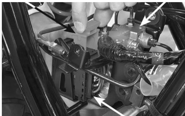
CONECTOR 25P DO MODULADOR DO ABS MODULADOR DO ABS
