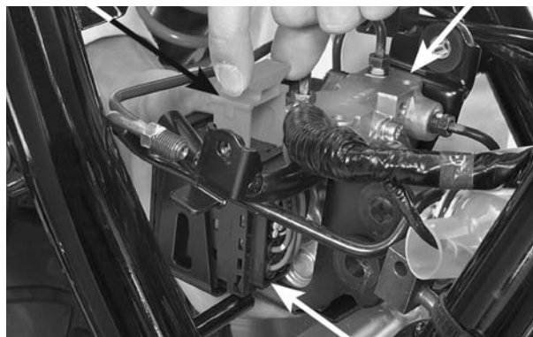
CONECTOR 25P DO MODULADOR DO ABS SUPORE
