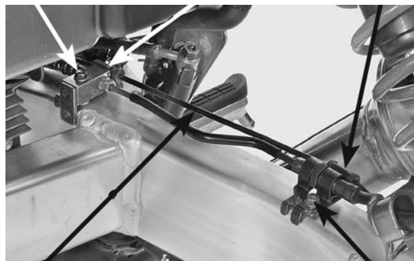
FIAÇÃO DO SENSOR PARAFUSO PRESILHA DA MANGUEIRA
