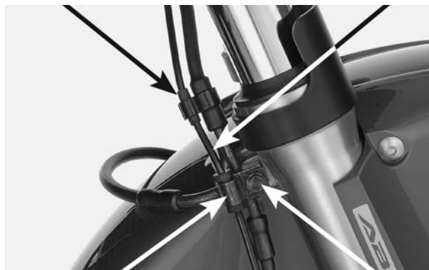
PLACA-GUIA FIAÇÃO DO SENSOR
