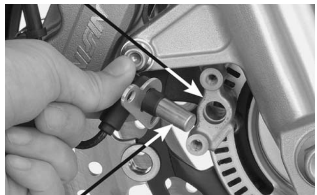
SENSOR DE VELOCIDADE DA RODA DIANTEIRA
